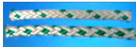
**TRECCIA SELEFLEX = Polipropilene multibave Alta Tenacità stabilizzato
